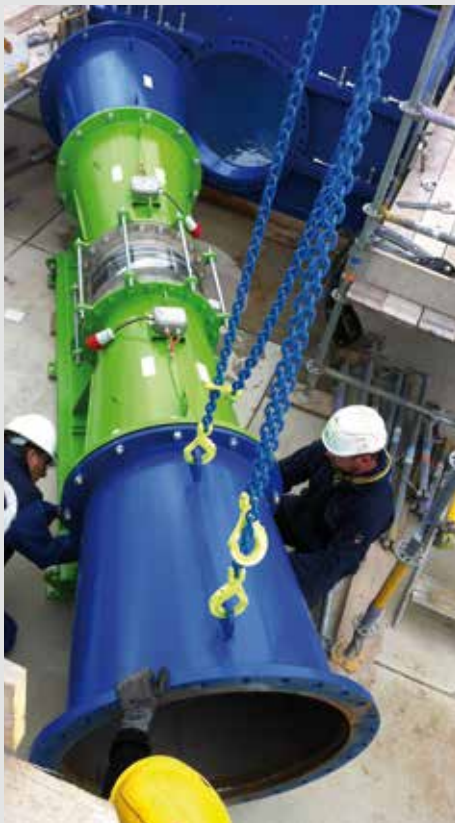
Het prototype van de bi-directionele getijde turbine is getest op efficiëntie en visvriendelijkheid bij de waterkrachtcentrale in Maurik.
